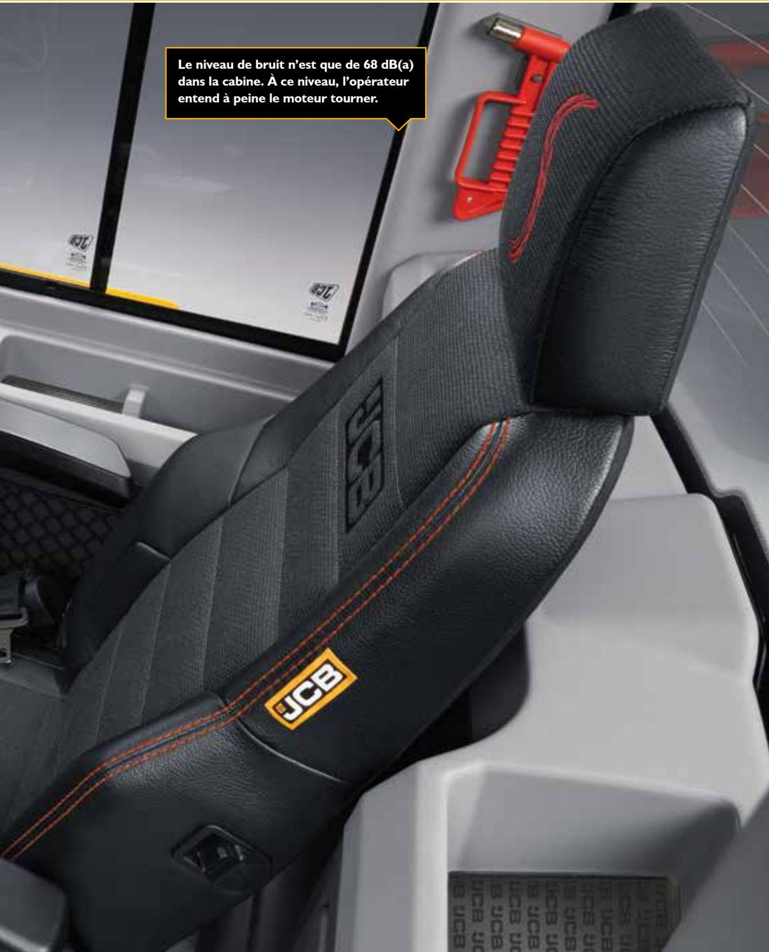
Pour maintenir un niveau de confort élevé dans la cabine à tout moment, celle-ci est équipée d'un système de pressurisation positive permettant d'éviter la pénétration de poussière et de fumées.
