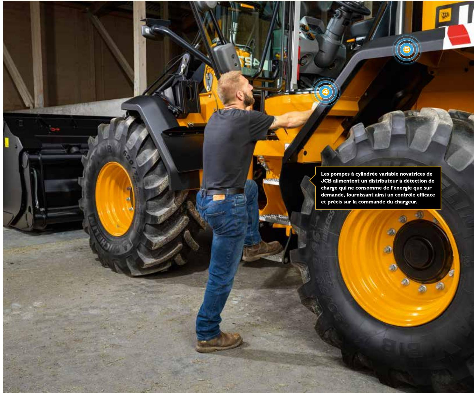
Les pompes à cylindrée variable novatrices de JCB alimentent un distributeur à détection de charge qui ne consomme de l'énergie que sur demande, fournissant ainsi un contrôle efficace et précis sur la commande du chargeur.
