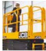
Stabiler Auftritt und heckseitige, manuelle Notsteuerung
