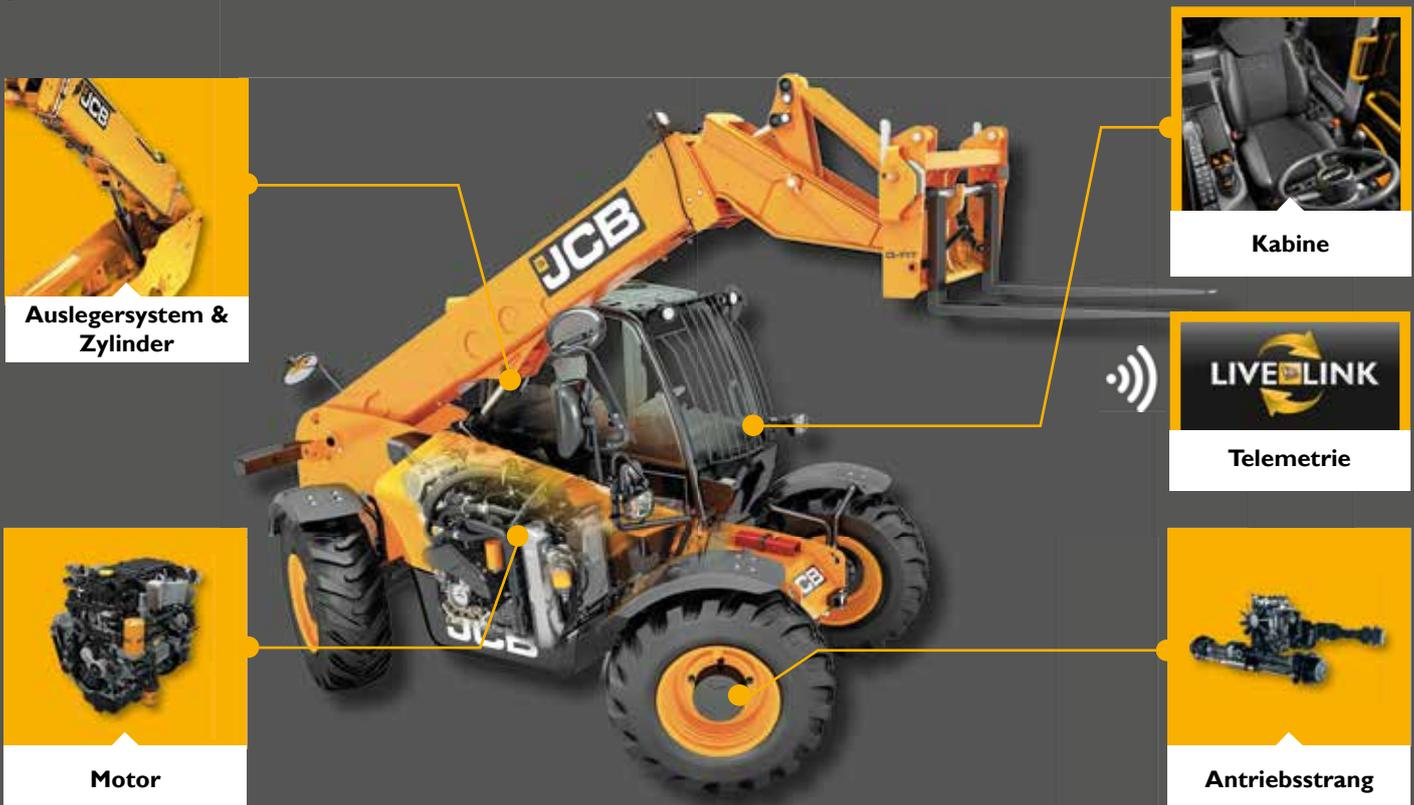
**Motoren:** Seit rund 20 Jahren entwickelt und produziert JCB auch eigene Motoren – z. B. den JCB DieselMax (mit bis zu 129 kW). Unser Vorteil: wir können die Motorsteuerung und die Verbräuche optimal auf das jeweilige Gewicht und den Einsatz der Maschine einstellen.
