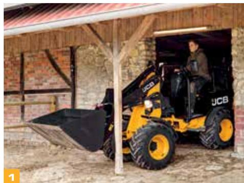
2 L'opzione con tettuccio pieghevole aumenta ulteriormente la versatilità della macchina, offrendo all'operatore la possibilità di ripiegare rapidamente il tettuccio in meno di 40 secondi per consentire l'accesso all'interno di edifici di altezza ridotta o di passare attraverso le porte.
