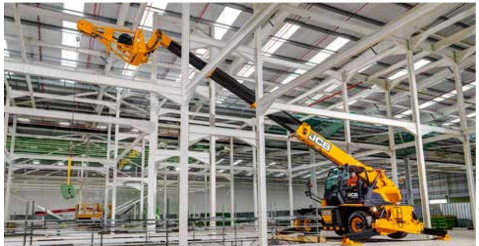
Mit der optionalen 5,5 Tonnen-Wagenwinde können Anwender Lasten in verwinkelten Einsatzorten manövrieren. Schnelle Seilgeschwindigkeit und zusätzlicher Ölkreis sorgen für die nötige Power und Produktivitätssteigerung.
