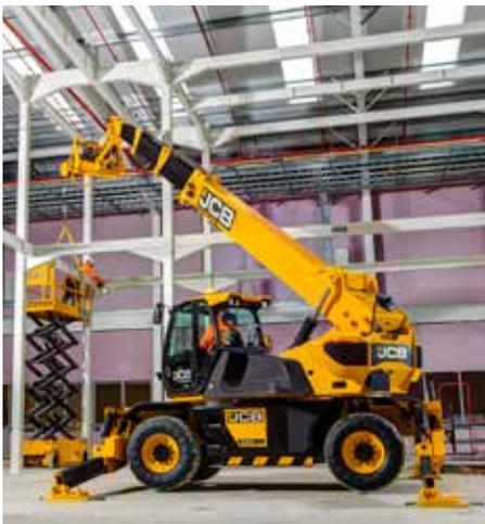
Spezielle One-Touch-Auslegerauslösung ermöglicht automatische Nivellierung und Stauung des Auslegers.
